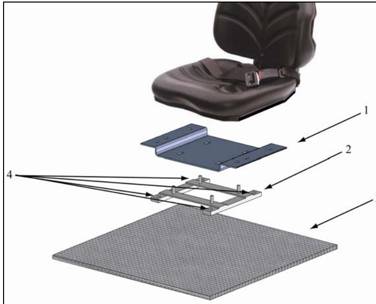
Figura 13 – Esempio di staffa a quattro punti di attacco (1 piastra del nuovo sedile, 2 staffa di collegamento, 3 struttura portante del trattore, 4 punti attacco della staffa alla struttura portante del trattore)
