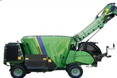
**FUNZIONE.** Il carro miscelatore per mangimi è una macchina utilizzata in agricoltura per miscelare i mangimi, dandogli la giusta consistenza per la somministrazione. Tali macchine sono in grado di desilare, ovvero estrarre il mangime dall'impianto di stoccaggio, generalmente un silos. Una volta preparato il prodotto lo distribuiscono direttamente nelle mangiatoie. Possono essere di tipo trainato o semovente.
