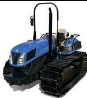
**FUNZIONE.** Il trattore a cingoli ha una funzione simile a quella del trattore a ruote ovvero permette il funzionamento delle altre macchine agricole fornendogli la potenza o la forza di trazione per funzionare. La peculiarità del trattore a cingoli rispetto a quello a ruote, è quella di avere una maggiore aderenza al suolo e quindi di poter lavorare su terreni difficili come quelli cedevoli e di sviluppare forze di trazione più elevate. Il limite è la lentezza di spostamento.
