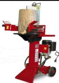
**FUNZIONE.** Lo spaccalegna è una macchina forestale che serve per spaccare in più parti un pezzo di legno o una sezione di tronco pretagliata. Lo spaccalegna ha due varianti, verticale e orizzontale e può essere azionato mediante il collegamento alla presa di potenza, da motore proprio elettrico o endotermico, o mediante le prese idrauliche del trattore.
