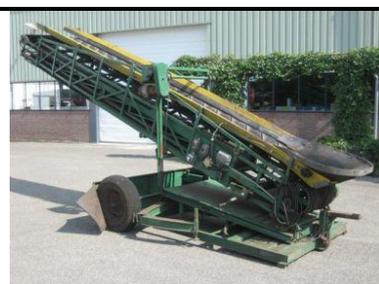
**FUNZIONE.** Il nastro trasportatore viene usato in agricoltura per la movimentazione dei prodotti agricoli. Ne esistono diverse versioni, il trasportatore a nastro di gomma, idoneo alla movimentazione di prodotti sciolti granulari; il trasportatore a nastro di tapparelle di legno, idoneo alla movimentazione di sacchi o cassette; il trasportatore a nastro a catene con canale in lamiera, idoneo alla movimentazione di foraggi sciolti o imballati.
