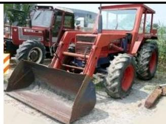
**FUNZIONE.** La pala caricatrice è una macchina movimento terra che viene utilizzata in agricoltura in tutte quelle situazioni dove è necessario rimuovere o spostare il terreno smosso: durante le opere di canalizzazione, nella pulizia dei canali, nelle opere di sbancamento finalizzate alla creazione del letto di semina e simili. Quando è collegata a trattore è di tipo portata. Altre conformazioni sono la versione semovente a cingoli e a ruote.
