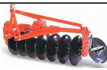
**FUNZIONE.** L'aratro a disco è una macchina agricola usata per la lavorazione del terreno. Rispetto all'aratro a versoio lavora a profondità minori e, oltre a rivoltare il terreno, lo sgretola lasciandolo più uniforme. E' una macchina di tipo portato o trainato.
