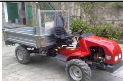
**FUNZIONE.** La motoagricola viene utilizzata principalmente per il trasporto di materiale sia su strada che fuori strada, su terreni difficili dove altri veicoli non possono andare. Per le sue caratteristiche la motoagricola può superare pendenze molto elevate. Alcune motoagricole sono dotate di presa di potenza potendo funzionare come dei piccoli trattori, categoria di macchinari agricoli alla quale appartengono.
