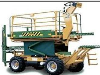
**FUNZIONE.** Il carro agevolatore per la raccolta e la potatura è una macchina che viene utilizzata in agricoltura per permettere agli addetti la raccolta dei frutti e la potatura di piante arboree. L'utilizzo di tale macchina risulta molto più agevole rispetto ad altri mezzi di elevazione come la scala a pioli. Sono macchine di tipo semovente e, quando sono usate nella raccolta, sono dotate di cassoni per il carico e lo scarico del prodotto raccolto.
