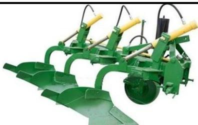
**FUNZIONE.** L'aratro è una macchina agricola utilizzata per la lavorazione del terreno. La sua funzione è quella di tagliare dal terreno una fetta di terra continua e di rivoltarla, così facendo si fanno emergere gli strati più fertili del terreno che andranno ad ospitare le sementi. E' una macchina che può essere di tipo portato o trainato. In commercio sono presenti molteplici varianti di aratro come il polivomere e il reversibile.
