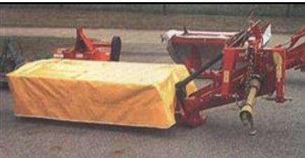
**FUNZIONE.** La falciatrice rotativa ad asse verticale viene utilizzata nello sfalciamento del foraggio. Ha il vantaggio rispetto agli altri tipi di falciatrice di poter lavorare su ampie sezioni di terreno. Spesso è associata a dispositivi di condizionamento, come per esempio dei rulli, che schiacciano il foraggio per favorire l'evaporazione dell'acqua in esso contenuta. La falciatrice rotativa è una macchina agricola di tipo portato.
