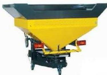
**FUNZIONE.** Lo spandiconcime viene utilizzato per distribuire sul terreno i prodotti fertilizzanti. A seconda che il concime sia in forma solida, liquida o gassosa vengono adottate diverse tecniche di spandimento. Nelle diverse varianti la macchina può essere di tipo portato collegato all'attacco a tre punti del trattore o trainato, dotato di carrello a ruote.
