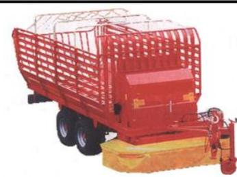
**FUNZIONE.** La falcia-caricatrice viene utilizzata per la raccolta del foraggio. Provvede in un'unica passata allo sfalco del prodotto ed al suo convogliamento nel cassone di carico. La falcia-caricatrice può essere di tipo semovente o trainato.
