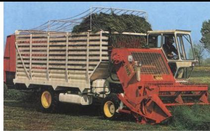
**FUNZIONE.** La falcia-trincia-caricatrice viene utilizzata per la raccolta del foraggio. Provvede in una unica passata allo sfalciamento ed alla triturazione del prodotto che viene raccolto sul pianale di carico. Alcune versioni di questa macchina sono dotate di sistemi di scarico laterale per distribuire nelle mangiatoie il foraggio precedentemente raccolto. La falcia-trincia-caricatrice può essere di tipo semovente o trainato.
