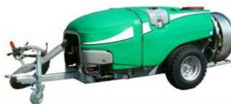
**FUNZIONE.** L'atomizzatore è una macchina utilizzata in agricoltura per distribuire i prodotti fitosanitari e i prodotti fertilizzanti liquidi nebulizzandoli uniformemente sulle colture da trattare. L'atomizzatore è una macchina di tipo portato, trainato o semovente.
