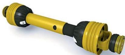
**FUNZIONE.** L'albero cardanico è un organo meccanico che permette la trasmissione del moto rotatorio da una trattore ad altre macchine agricole. La trasmissione del moto può essere fornita ad una macchina che lavora in posizione fissa, come una pompa per liquami, alle ruote motrici di una altra macchina, come un rimorchio agricolo, a macchine trainate o portate che operano al seguito della trattore, come una zappatrice.
