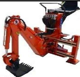
**FUNZIONE.** L'escavatore è una macchina movimento terra che viene utilizzata in agricoltura per opere di canalizzazione, per opere di sbancamento finalizzate alla risistemazione dei terreni agricoli, per la costruzione di argini e la pulizia dei canali. Quando è collegato al trattore è una macchina di tipo portato. Altre conformazioni sono la tipologia semovente a cingoli e a ruote.
