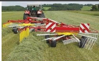
**FUNZIONE.** Il ranghinatore rotativo, detto anche a trottole, viene utilizzato per la formazione delle andane (strisce continue di foraggio sfalciato cumulate sul terreno prima di essere raccolte), per il rivoltamento del foraggio e per il suo spandimento. Il ranghinatore rotativo è una macchina di tipo portata o trainato.
