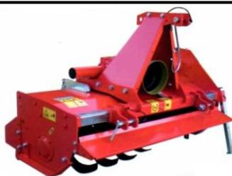
**FUNZIONE.** La zappatrice è una macchina agricola che viene utilizzata per funzioni molteplici quali l'affinamento del terreno dopo l'aratura, per eliminare le erbe infestanti, per interrare le sementi una volta distribuite sul terreno, per rompere le croste superficiali del terreno in modo da facilitare la crescita delle piante. Viene anche utilizzata alternativamente all'aratro per un lavoro di dirompimento del terreno più superficiale. Può essere di tipo portata o trainato.
